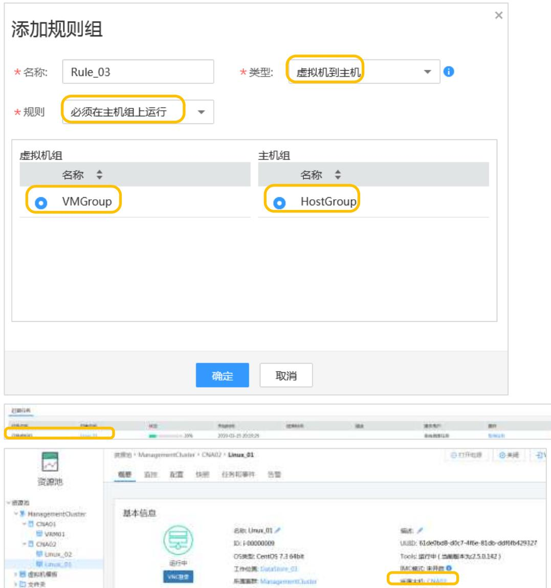
任务显示系统自动将虚拟机 Linux\_01 从主机 CNA01 迁移到了主机 CNA02 上，即虚拟机 Linux\_01 和 Linux\_02 都运行在指定的主机上。
