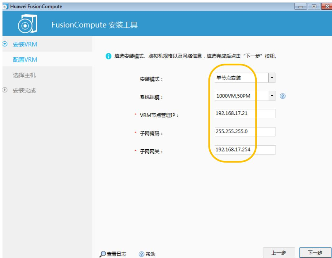
步骤 8 单击“下一步”，进入“选择主机”界面。按如下方式配置主机，单击“开始安装 VRM”，等待 VRM 安装完成，安装时间预计为 45min。
