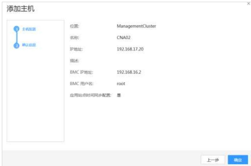
步骤 4 等待 CNA02 主机图标颜色由红色转为蓝色后，表示该 CNA02 主机添加完成。
