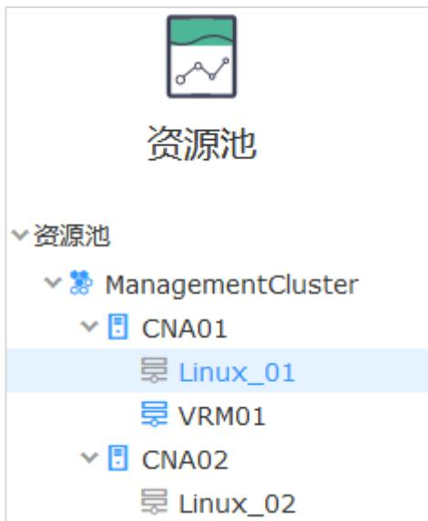
步骤 7 右键单击待操作的虚拟机名称，选择“电源 > 打开电源”，单击“确定”，打开虚拟机。
