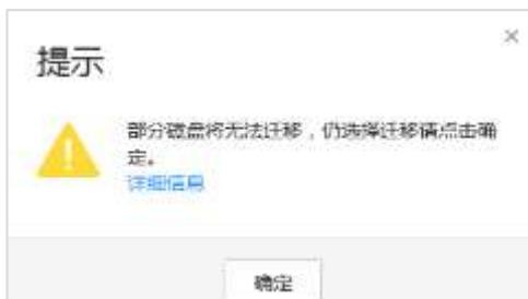
步骤 8 返回更改数据存储页面，在页面下方的列表中，查看不支持迁移的磁盘和不支持迁移原因，同时可对支持迁移的磁盘修改目的配置模式，完成后单击“确定”。
