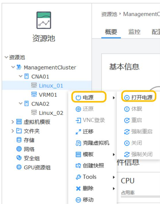
步骤 8 参考步骤 7，打开虚拟机 Linux\_02。
