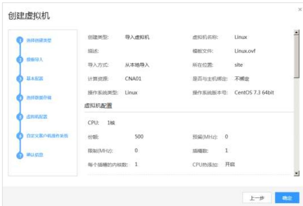
步骤 5 弹出导入虚拟机页面，待提示“成功提交导入虚拟机任务”后，关闭该页面。
