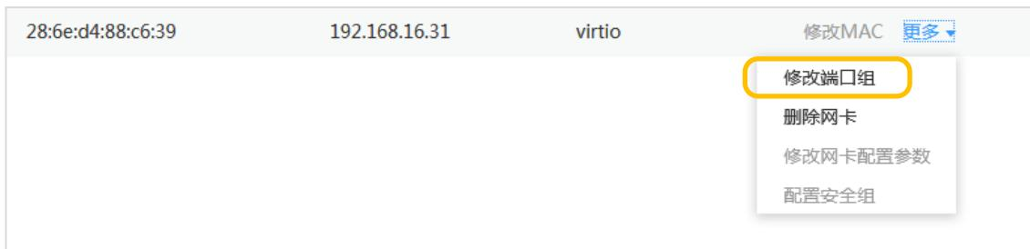
在弹出的提示对话框中选择“确定”，然后选择新的端口组。
