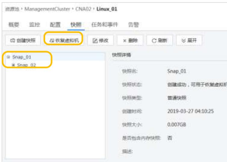
步骤 10 选择快照列表中的第一个快照 Snap\_01，单击上方的“恢复虚拟机”，弹出信息提示框，单击“确定”，对虚拟机进行快照还原。
