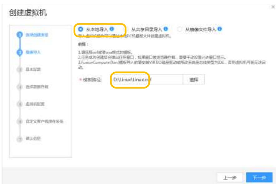
步骤 3 参考 4.1.1 中的步骤 4~6，完成虚拟机相关配置（直接单击“下一步”，保持默认即可）。在自定义客户机操作系统页面，取消勾选“生成系统初始密码”，单击“下一步”。
