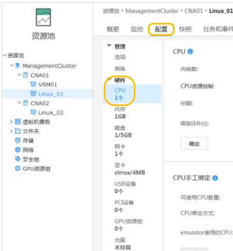
步骤 2 单击“内核数”后面的“+”，将 CPU 内核数调整为 2，单击“确定”。
